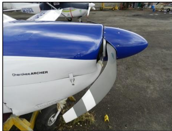
Flexión en las palas de la hélice y parada súbita del motor
