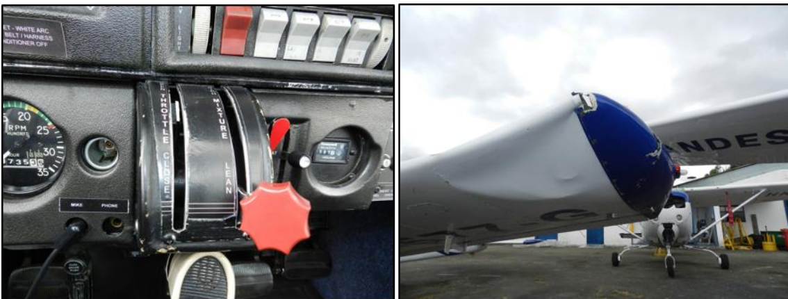
Fractura de la palanca de aceleración y abolladura del borde de ataque del plano izquierdo
